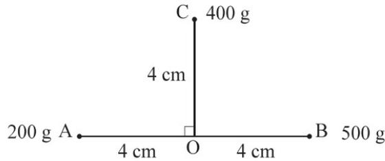
දිග 8 cm වූ AB සරල රේඛාවේ A කෙළවරෙහි 200 g ස්කන්ධයක් B කෙළවරෙහි 500 g ස්කන්ධයක් ද ඇත. AB හි ලම්බ සම්ච්ඡේදකය වූ OC රේඛාවෙහි O සිට 4 cmක් දුරින් පිහිටි C ලක්ෂ්‍යයෙහි 400 g ස්කන්ධයක් ද තබා ඇත.
