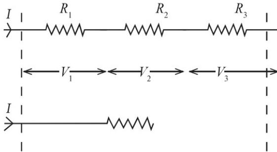
එකම ධාරාව ගෙනයන පරිදි ප්‍රතිරෝධක කීපයක් යාකොට තිබෙනම් එය ශ්‍රේණි ගත සම්බන්ධයකි. එම ධාරාවම ගෙනයමින් මුල් ප්‍රතිරෝධය හරහා පවත්නා පූර්ණ විභව අන්තරය පවත්වා ගන්නා තනි ප්‍රතිරෝධකයේ ප්‍රතිරෝධය මුල්, ප්‍රතිරෝධ පද්ධතියේ සමක ප්‍රතිරෝධයයි.
