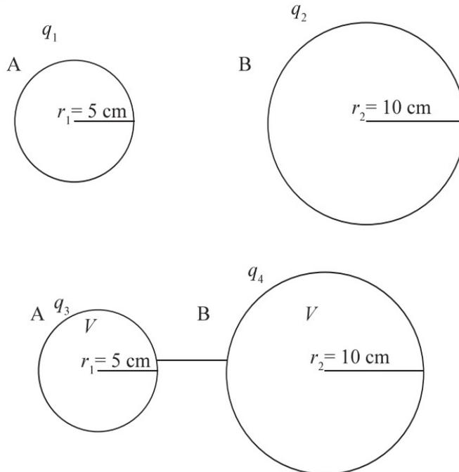
A ගෝලයේ ධාරිතාව  $C_1 = 4\pi\epsilon_0 r$ , B ගෝලයේ ධාරිතාව  $C_2 = 4\pi\epsilon_0 r$  ගෝල යා කළ විට ඒවා එකම විභවයකට ( $V$ ) එළඹෙන අතර ඒවායේ ඉතිරි වන ආරෝපණ පිළිවෙලින්  $q_3$  සහ  $q_4$  යයි සිතමු.
