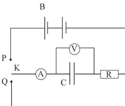
ධාරිත්‍රකයක් ආරෝපණය කිරීම සහ පසුව විසර්ජනය කිරීම සඳහා 4.4 රූපයෙහි දක්වා ඇති ආකාරයේ පරිපථයක් යොදා ගත හැකි ය. C යනු ආරෝපණය කළ යුතු  $100 \mu\text{F}$  ක් පමණ වූ ධාරිත්‍රකයකි. R යනු මෙගා ඕම් ( $M\Omega$ ) ප්‍රමාණයේ අධික ප්‍රතිරෝධයකි. K යනු දෙමං ස්විච්චයක් වන අතර B යනු 6V පමණ වූ සරලධාරා ප්‍රභවයකි. A යන මයික්‍රො ඇමීටරය සහ V ප්‍රභවයේ වෝල්ටීයතාවට සරිලන V වෝල්ටීයමීටරය දක්වා ඇති පරිදි පරිපථයට සම්බන්ධ කර ඇත.
