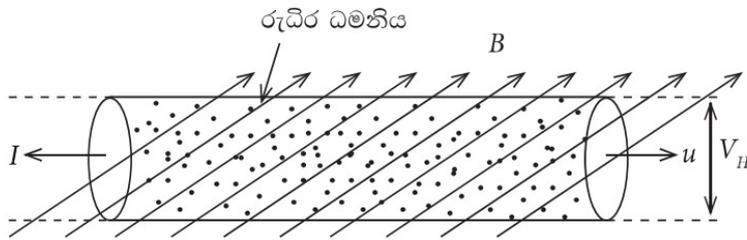
ඉහත රූපයේ දක්වා ඇති පරිදි විද්‍යුත් චුම්බක ප්‍රවාහ මීටරයකින් පරීක්ෂාවට ලක්වන රුධිර ධමනියක් හරහා එයට ලම්බව ප්‍රාච සන්නත්වය  $B$  වන ඒකාකාර චුම්බක ක්ෂේත්‍රයක් ක්‍රියාත්මක කර ඇත. රුධිරයේ අඩංගු  $\text{Na}^+$  සහ  $\text{Cl}^-$  අයන ආරෝපණ වාහක ලෙස රුධිරය සමග ප්‍රවාහ වන හෙයින් චුම්බක ක්ෂේත්‍රයට ලම්බව ධමනිය හරහා හෝල් වෝල්ටීයතාවක් පැන නගී. ප්‍රවාහ මීටරයෙන් දැක්වෙන එහි අගය  $V_H$  වේ. අයනවල ප්‍රවාහ වේගය රුධිරයේ ප්‍රවාහ වේගයට සම වේ යැයි සලකා රුධිරයේ ප්‍රවාහ වේගය සඳහා ප්‍රකාශනයක් ලබා ගන්න.
