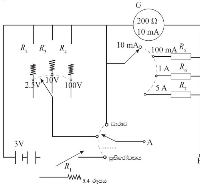
ඉහත දක්වා ඇති බහු මීටරය, ප්‍රතිරෝධය  $200 \Omega$  වූ ද, පූර්ණ පරිමාණ උත්ක්‍රමණය  $10 \text{ mA}$  වූ ද ගැල්වනෝමීටරයක් යොදා නිර්මාණය කරන ලද්දකි. A සහ B යනු උපකරණයේ අග්‍ර වේ.  $R_1$  යනු ඕම් මීටරයේ නිත්‍යව තබා ගනු ලබන ප්‍රතිරෝධයයි.
